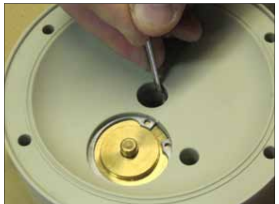
Fig 10. Si les joints d'arbre (36) semblent usés (fuite d'air interne), les enlever délicatement avec un outil pointu. Durant cette opération, le joint (36) et joint torique (47) sont généralement détruits, assurez vous de pouvoir les changer.
