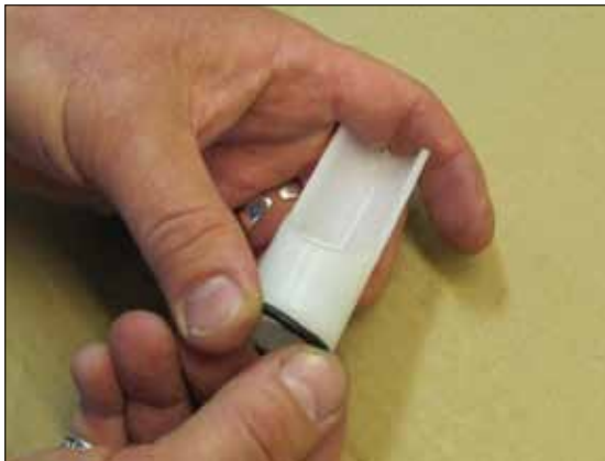
Fig 13. Placer le clapet bille (23) dans le siège bas (21) et monter la butée (22). Monter le joint de siège (43) en dessous celui ci (21)
