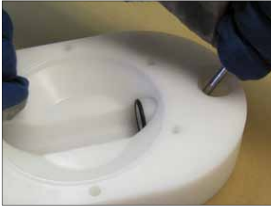
Fig 6. Poussez le siège haut (20), attention de ne pas endommager les bords du trou de manifold.
