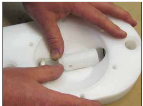
Fig 16. Placer l'entretoise (19) vers le bas et la pousser contre le siège haut (20).
