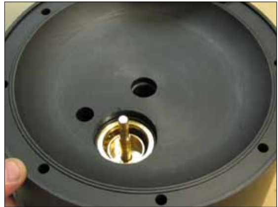
Fig 14. Maintenant que les deux extrémités sont enlevées, pousser à la main l'arbre et le piston.
