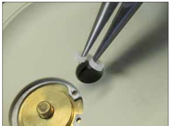
Fig 10. Afin de positionner les joints d'arbre (36), pincez le et insérez le délicatement dans la gorge.
