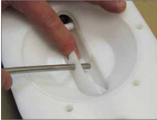
Fig 17. Mettre une tige filetée dans le trou de l'entretoise (19) et la tourner doucement. Frapper délicatement avec un maillet pour finir le placement de l'entretoise.
