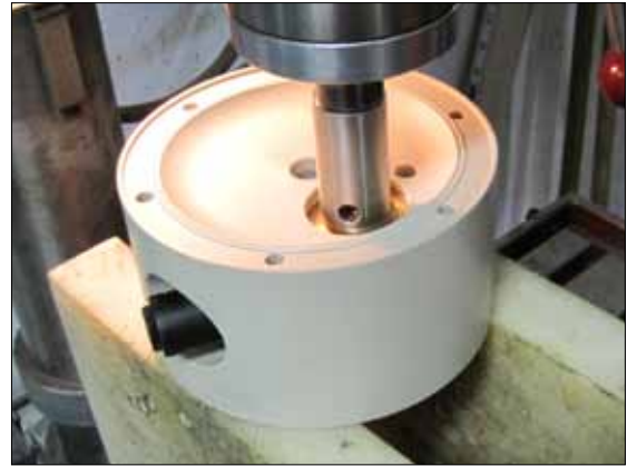
Fig 12. Pousser le distributeur d'air (6) avec une presse. Attention de ne pas endommager les côtés du distributeur d'air en bronze
