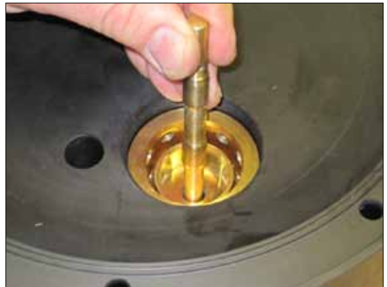
Fig 8. Placer le piston et l'arbre à la main. Répéter les étapes Fig 3 et Fig 4 sur le côté restant. Fixer les extrémités de manière égale sur chaque côté.
