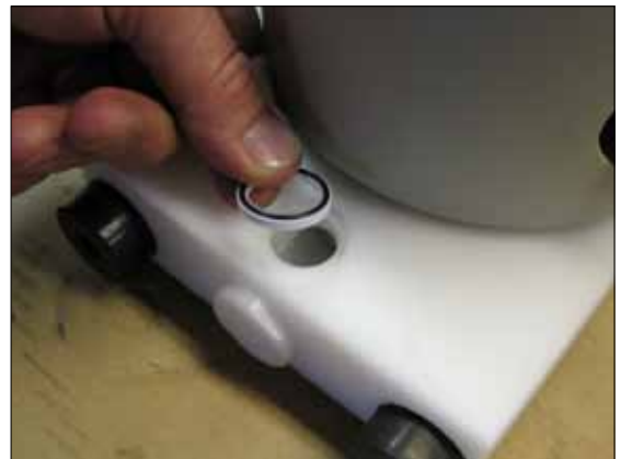
Fig 21. Mettre le joint torique (pos 18) dans le corps. Sur les pompes avec membranes PTFE le joint U en PTFE avec son joint torique doit être placé avec le joint torique vers le haut see Fig. 21).
