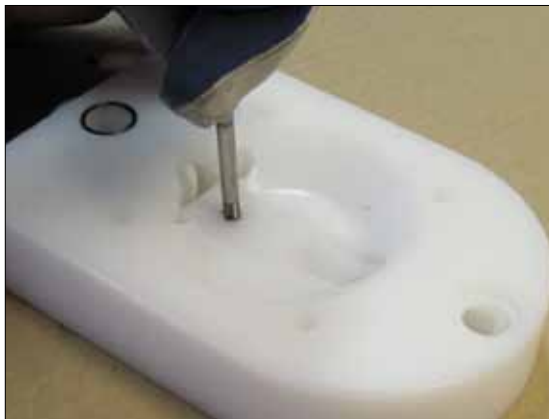
Fig 7. Visser une tige filetée dans le trou de l'entretoise (19). Sur les nouveaux modèles de TR9 ce trou n'existe pas, la soulever alors avec un tournevis.
