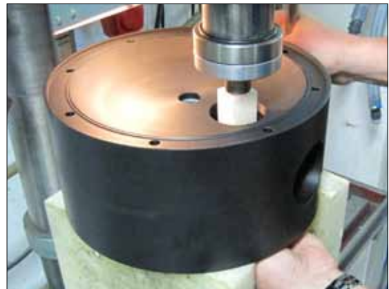
Fig 16. Presser le cylindre, sans endommager les bords de celui ci.
