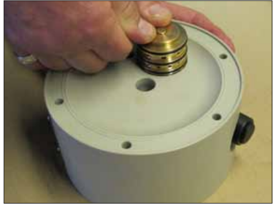
Fig 2. Mettre un peu d'eau sur les joints toriques, ne pas utiliser d'autre lubrifiant. Pousser délicatement le distributeur (61) dans le corps. Mettre le circlip (27) du côté restant (fig. 1).
