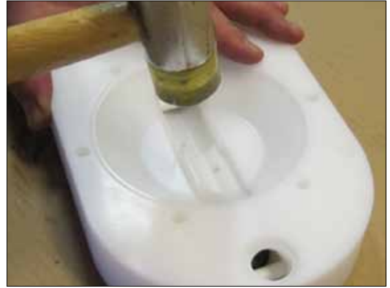
Fig 18. Assurez vous que l'ensemble sièges et entretoise soit à plat dans le corps.
